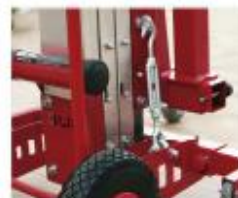
Sistema ajustable de bloqueo de los perfiles para el transporte en horizontal.
